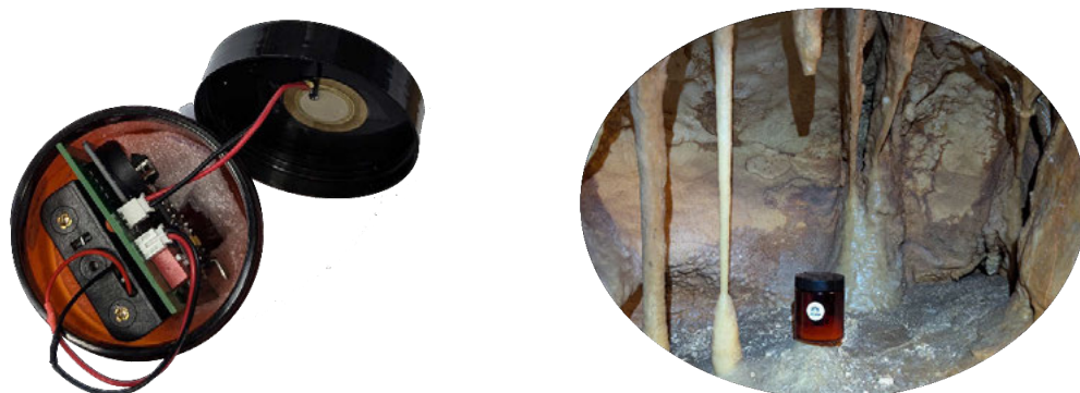
Figura 3. Izquierda, equipo dentro del bote. Derecha, bote en posición de registro de gotas
